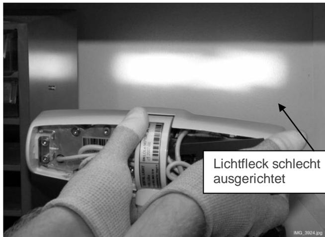
2- Die Schrauben auf den Opteled mit einem Inbus 2.5mm ein bisschen abschrauben und den Opteled in der richtigen Lage ausrichten.
